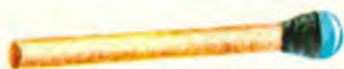
پایه برای نگاه داشتن جواهرات هنگام بریدن و صیقل دادن آنها
