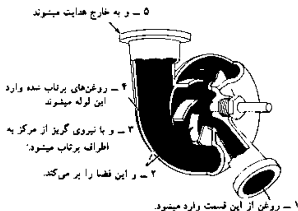
(شكل ۷ - ۷) پمپ گريز از مركز و طرز كار آن
