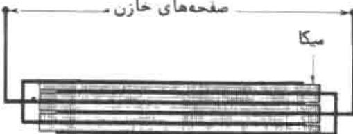
شکل ۱۱-۷ - خازن با ورقه‌های نازک میکا
