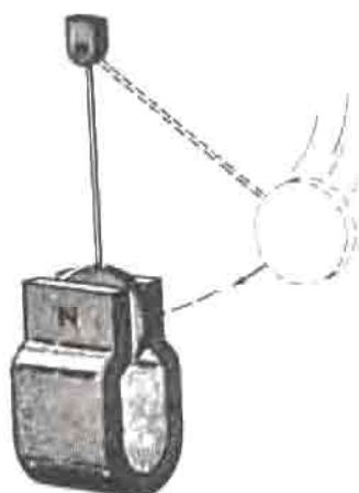
شکل ۱۴-۸ - القاء جریان الکتریکی در میدان مغناطیسی یک پاندول در میدان مغناطیسی نوماد می‌کند سبب می‌شود که حرکت پاندول سست کند شود و متوقف گردد.
